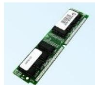
**Memória RAM**, é uma memória que **permite** o **acesso** aos arquivos armazenados **no** computador. **Armazena** os **conteúdos** temporariamente e determina a **velocidade** que o **computador** funciona.
