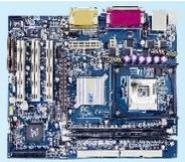
**Placa-mãe**, também denominada **mainboard** ou **motherboard**, é uma **placa de circuito impresso**, que **serve** como base para a **instalação** dos demais componentes de um computador, como o **processador** e a **memória RAM**
