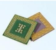
O **processador** é um circuito integrado que **realiza funções** de cálculos e tomadas de decisões de um computador. Por isso é **considerado** o **cérebro** do computador. Ele também pode ser chamado de **Unidade Central de Processamento** ou **CPU** que em inglês significa **Central Processing Unit**.
